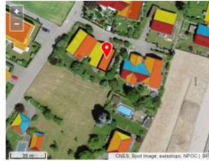
Abbildung 2 Darstellung Solarpotenzial (rot hervorragend, orange gut, gelb mittel, blau gering)
